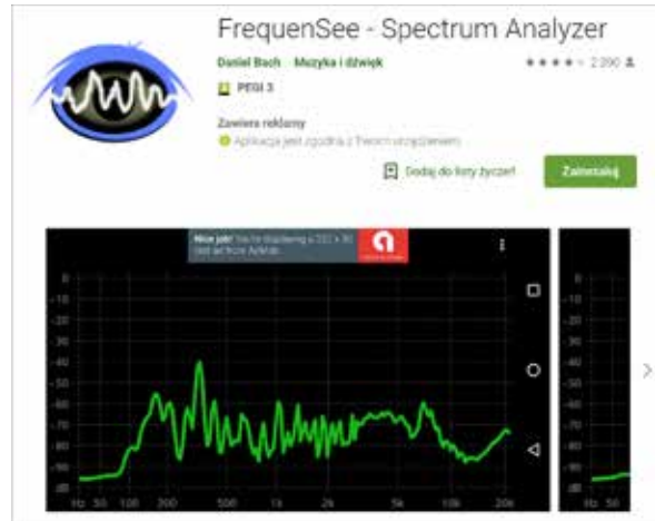
Rysunek 13. FrequenSee Spectrum Analyser – prosta aplikacja do obserwacji widma dźwięku.
