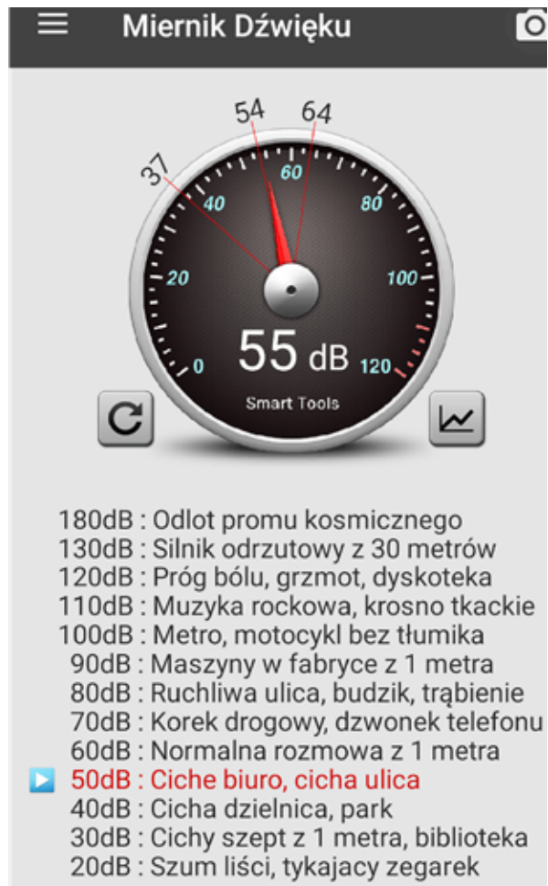
Rysunek 14 i 14a. Miernik dźwięku Sound Meter przedstawia poziom natężenia dźwięku w dB na wykresie i odnosi bieżący wynik do typowej sytuacji.
