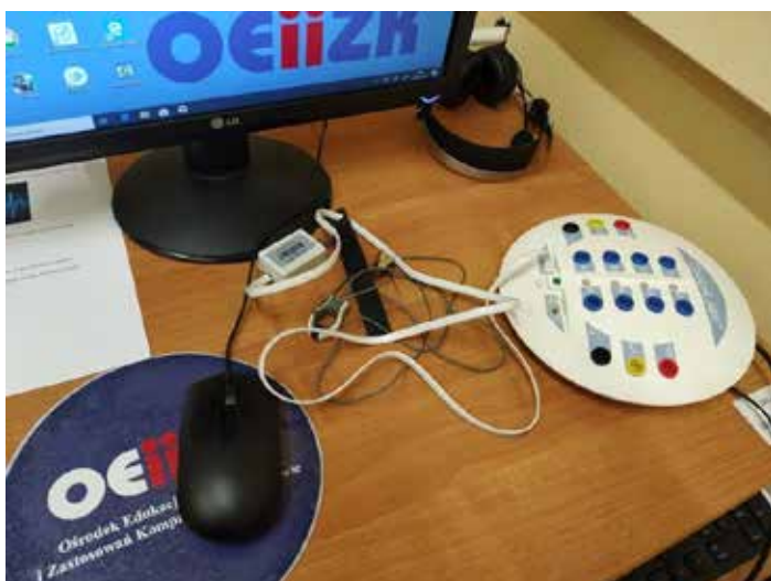
ILUSTRACJA 6. Interfejs pomiarowy CoachLab II+ wykorzystywany w czasie zajęć w OEIiZK (materiał własny)
