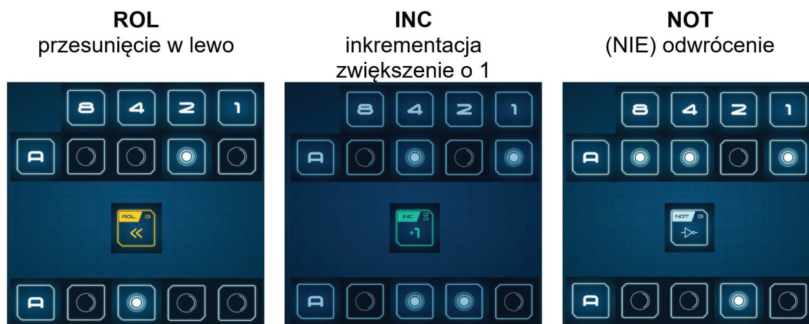
ILUSTRACJA 2. Przykładowe operacje przeprowadzane na bitach procesora
