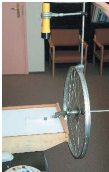
Rysunek 9. Badanie zależności oświetlenia od kąta padania
