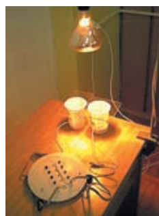
Rysunek 7. Efekt cieplarniany – zdjęcie układu doświadczalnego i wyniki pomiarów temperatury wewnątrz pojemników.
