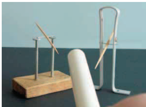
Igły elektrostatyczne do badania oddziaływań i pól elektrostatycznych wykonane przez uczniów
