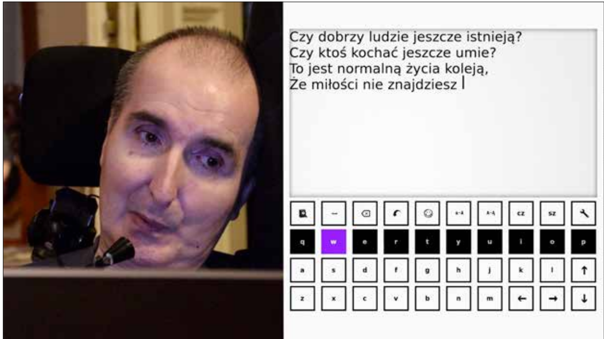
Rysunek 9. Sterowanie PISAKiem za pomocą przetacznika uruchamianego oddechem (ang. sip and puff interface)
