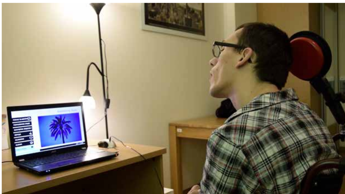
Rysunek 8. Sterowanie PISAKiem za pomocą przetącznika wciskanego głową
