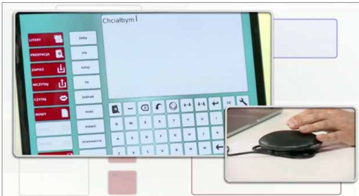
Rysunek 7. Pokaz działania programu PISAK (w górnej ramce) sterowanego przetącznikiem (w dolnej ramce) z wywiadu wideo „Jak wnknąć w umysły ludzi w śpiączce” w programie „Teraz nauka” serwisu newsweek.pl 11 . Wciśnięcie przycisku wybiera znak lub grupę podświetlaną na ekranie komputera
