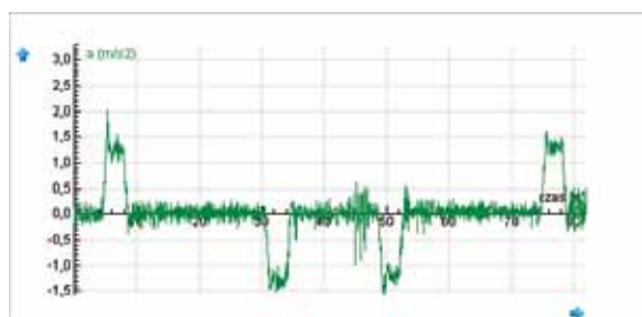
Rys. 13. Zmiany przyspieszenia windy wyznaczone na podstawie pomiarów z rys. 11
