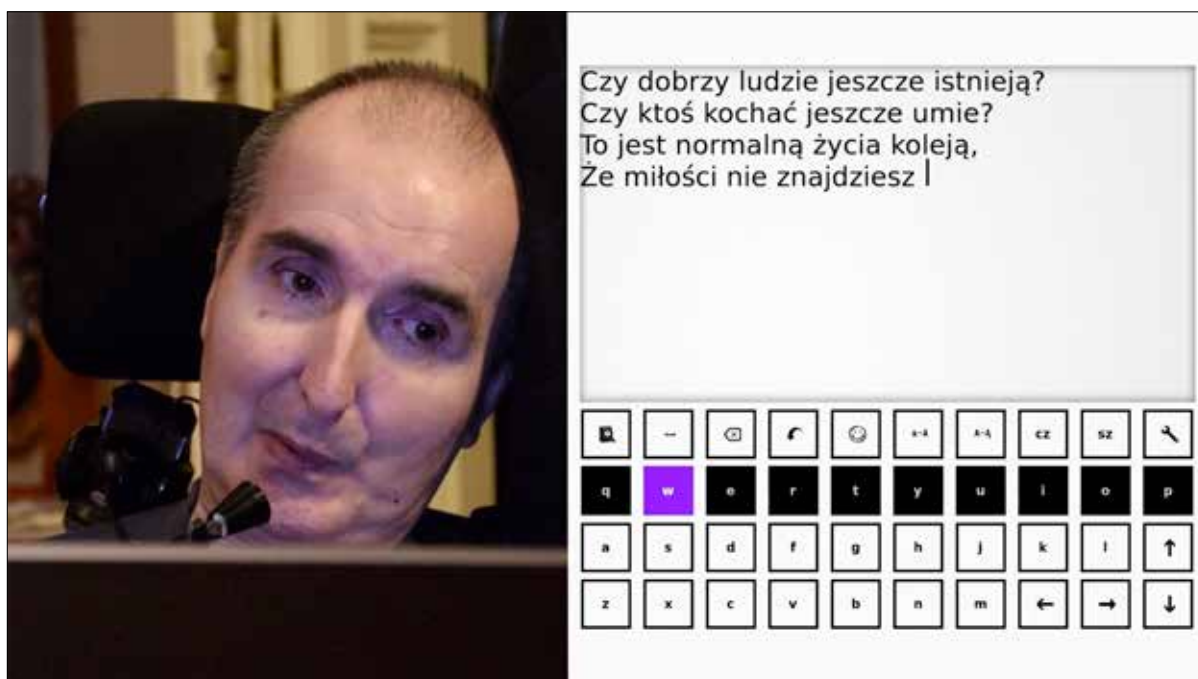
Rysunek 9. Sterowanie PISAKiem za pomocą przetącznika uruchamianego oddechem (ang. sip and puff interface)
