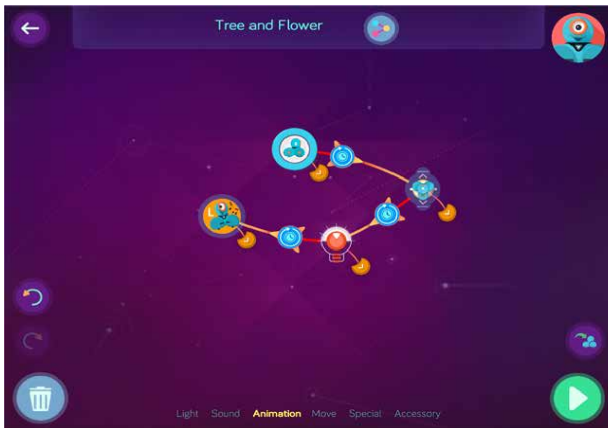
Rysunek 9. Aplikacja Wonder pozwala zaprogramować robota przez określenie stanów oraz warunków przejścia między nimi (np. po uruchomieniu programu, czekaj na kłaśnięcie dłońmi, a następnie zapal na czerwono diody w uszach, następnie odczekaj 2 sekundy i przejedź 20 centymetrów do przodu).
