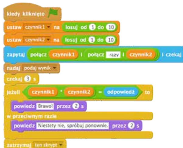
Rysunek 4. Przykładowy skrypt duszka zadającego pytanie.
