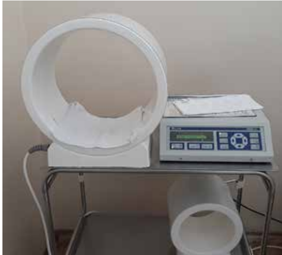
Rysunek 11 i 11a. Stosowane w rehabilitacji cewki, wytwarzające zmienne pole magnetyczne i wyniki pomiarów (po prawej).
