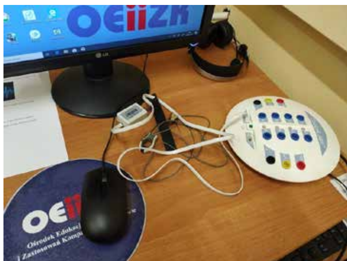
ILUSTRACJA 6. Interfejs pomiarowy CoachLab II+ wykorzystywany w czasie zajęć w OEiZK (materiał własny)
